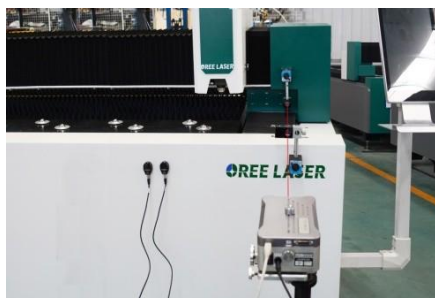
Badanie dokładności pozycjonowania - oś Y
