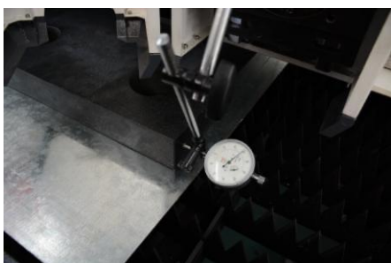
Testowanie dokładności w trzech osiach
