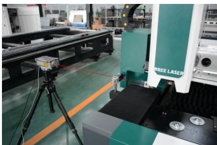
Badanie dokładności - oś X
